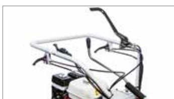
Dirección con desbloques y frenos independientes.
