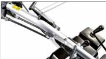
Inversor rápido con palanca de mando en el manillar: permite invertir el sentido de marcha sin intervenir en las marchas.
