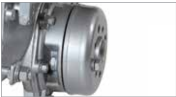
Semiejes reforzados con reductores integrados en el cambio para mayor agarre en terrenos difíciles.
