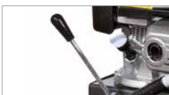
Mando selector de velocidades con palanca.
