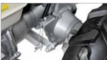
Embragues de dirección con mando combinado con los frenos: permiten hacer virajes de 360° con un mínimo radio de giro.
